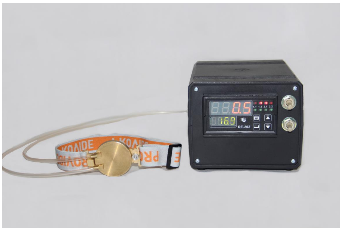
Рис. 1. Експериментальний зразок термоелектричного приладу у вигляді монокулярної пов'язки для контактного охолодження ока людини через повіки: 1 – охолоджуюча пластина, 2 – термоелектричний електронний блок охолодження, керування та живлення
