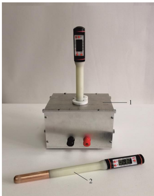
Рис. 1. Термоелектричний прилад для лікування захворювань шкіри: 1 – термоелектричний блок охолодження, 2 – робочий інструмент
