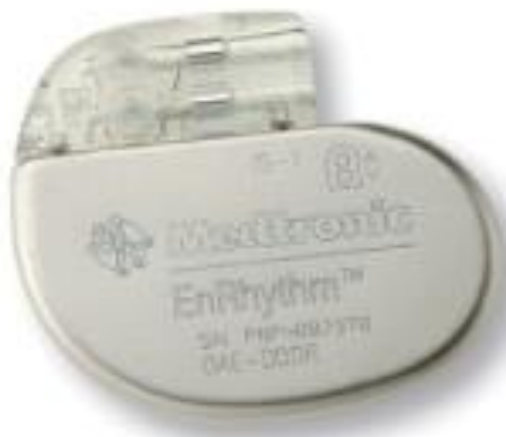
Рис. 4. Імплантований двокамерний ЕКС [31]
