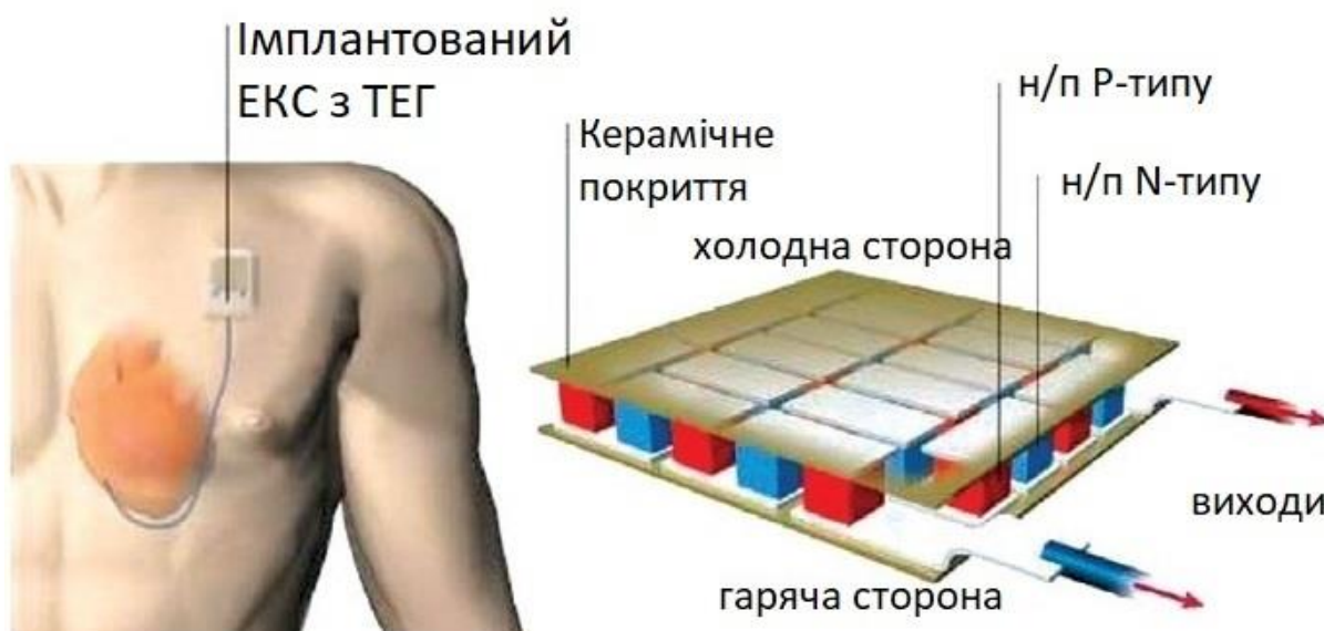
Рис. 15. Схематичне зображення імплантованого ЕКС з ТЕГ [49, 55]
