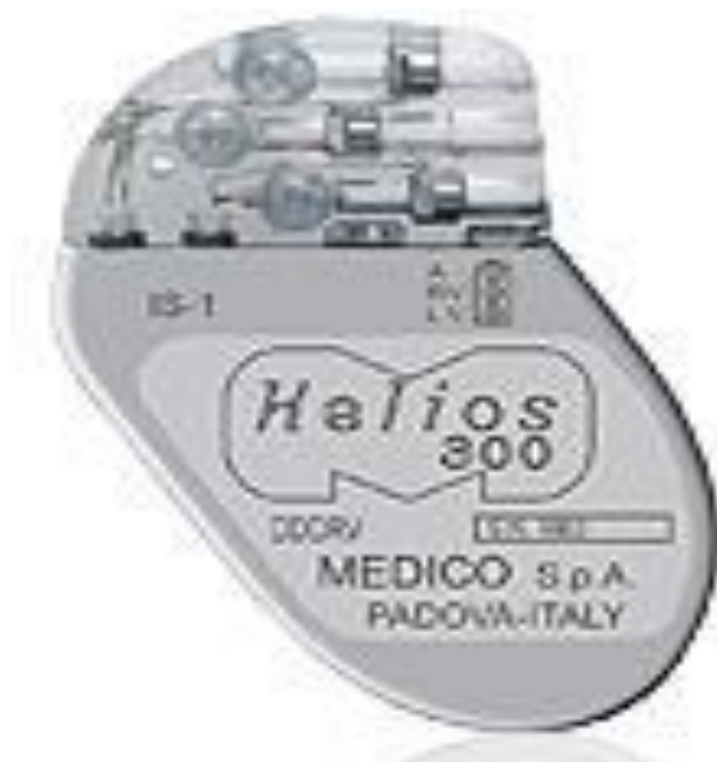
Рис. 5. Імплантований трикамерний ЕКС [31]
