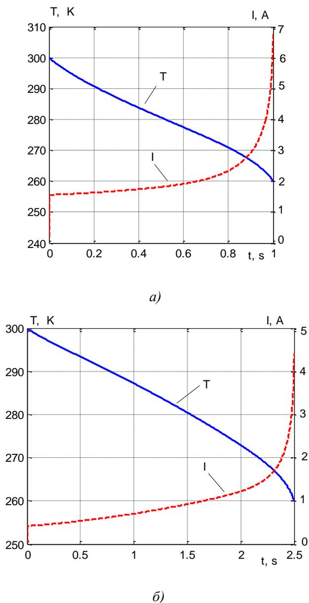
Рис. 2. Оптимальні функції струму і відповідні їм функції пониження температури від 300 К до 260 К за час 1 с (а) і 2.5 с (б).
