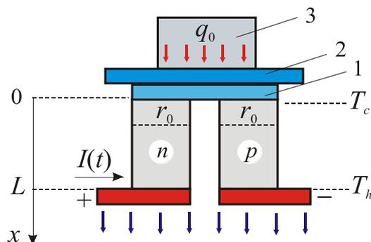
Рис. 1. Модель термоелемента для оптимізації процесу нестационарного охолодження.
