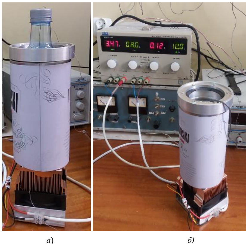
Рис. 1. Прототип побутового термоелектричного охолоджувача напоїв TSSN-0.5 [3]: а - загальний вигляд, б - момент випробувань.
