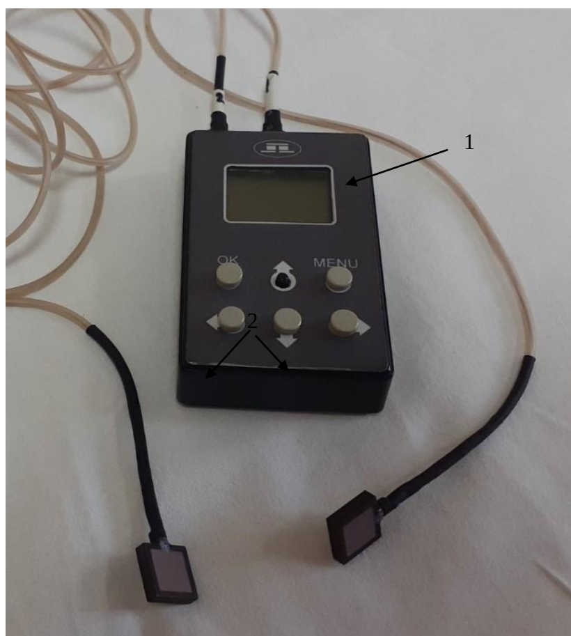
Рис. 1. Термоелектричний прилад для діагностики запальних процесів та больового синдрому при дегенеративно-дистрофічних захворюваннях попереково-крижового відділу хребта людини: 1 – блок керування, 2 – термоелектричний сенсор температури і теплового потоку
