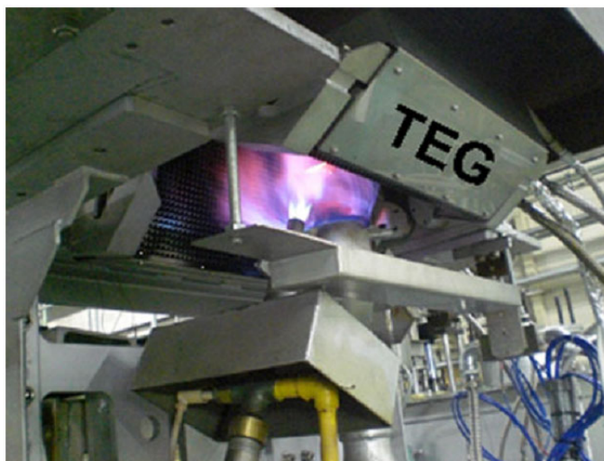
Рис. 4. Установка термоелектричного генератора на цементній печі заводу Awazu компанії Komatsu (Японія) [31].
