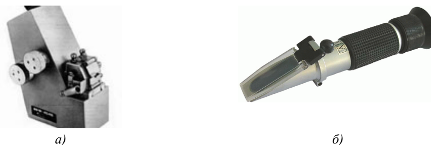
Рис. 2. Рефрактометри: а) – лабораторний ІРФ 454Б2М, б) – карманний VBC4T.
