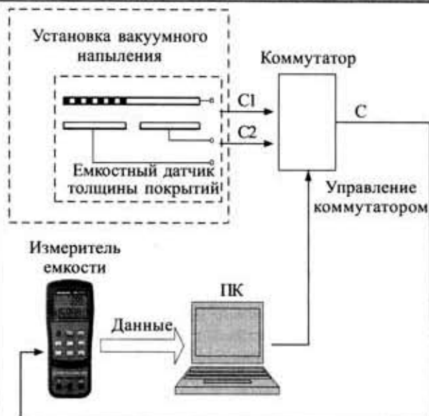
Рис. 8. Автоматизированная система контроля толщины покрытий
