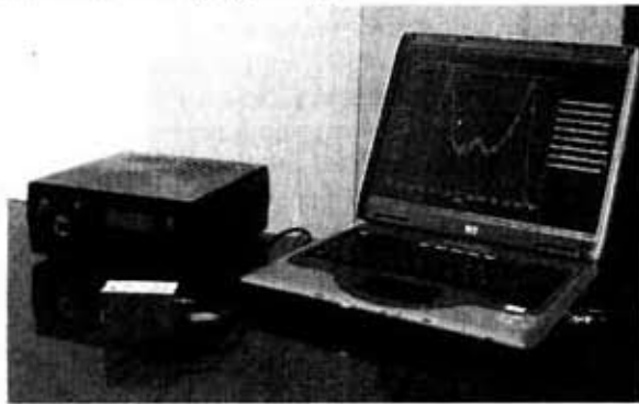
Рис. 6. Спектрометр рентгеновского излучения
