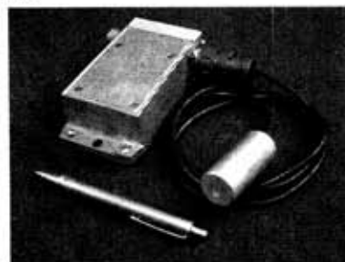
Рис. 1. Блок детектирования для контроля мощности дозы рентгеновского излучения
