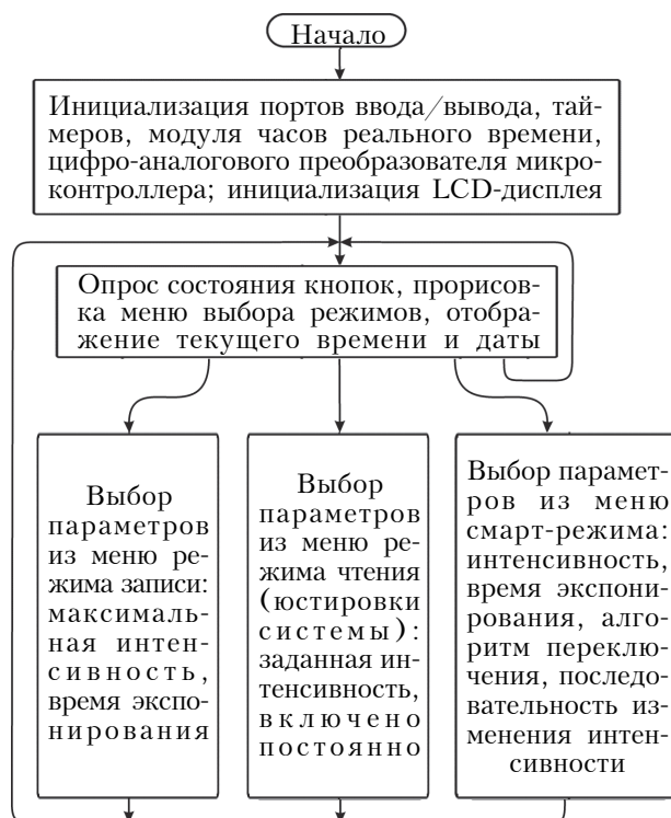
Рис. 3. Блок-схема алгоритма работы микроконтроллера STM32F100RB
