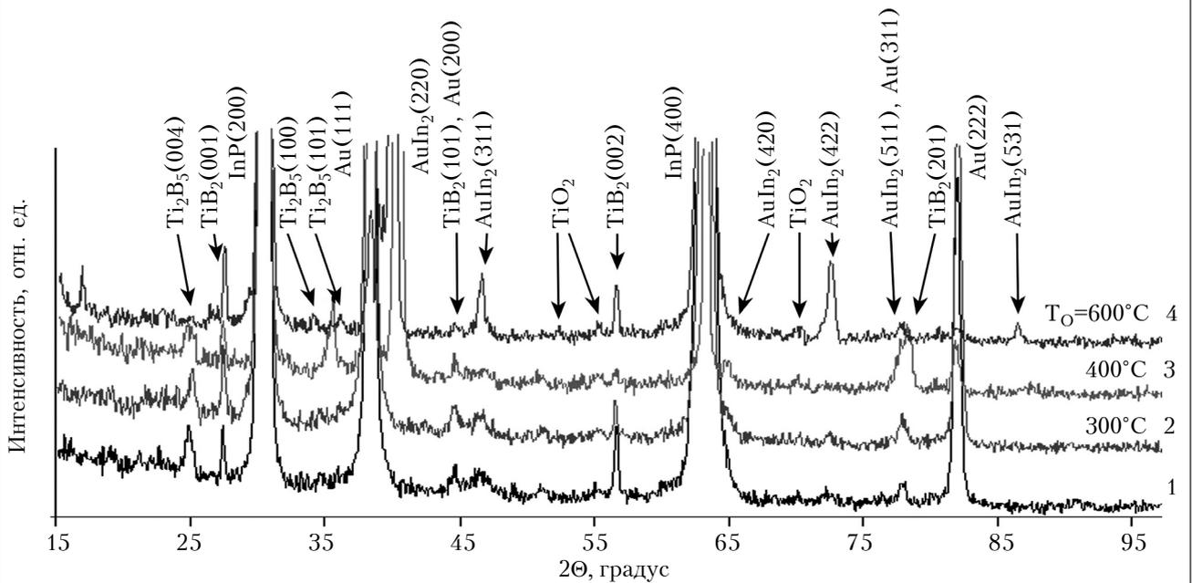
Рис. 13. Рентгенодифрактограммы системы Au-TiB<sub>x</sub>-Ge-Au-InP до отжига (1) и после БТО при разной температуре (2–4) [4]
