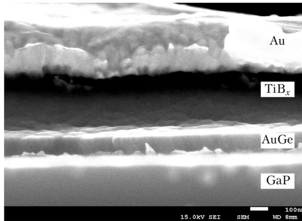
Рис. 9. Морфология скола контакта Au-TiB<sub>x</sub>-Au-Ge-GaP
