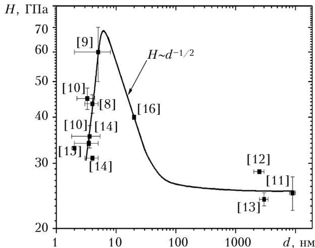
Рис. 1. Зависимость микротвердости слоя  $TiB_2$  от размера зерна (по данным из источников, указанных на рисунке)
