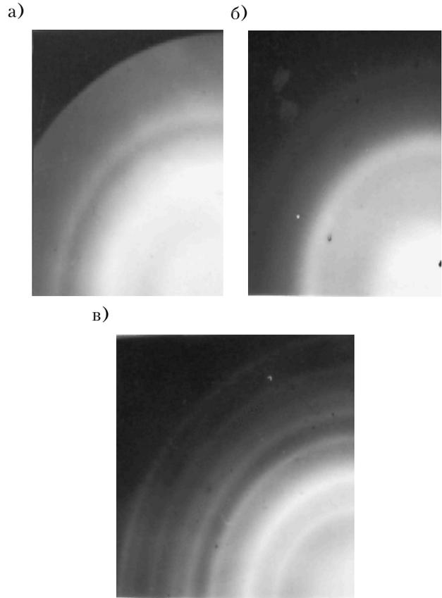
Рис. 2. Электронограммы пленок  $TiB_x$ , полученных при различных значениях тока распыления [19]: а — 0,2 А; б — 0,4 А; в — 1 А
