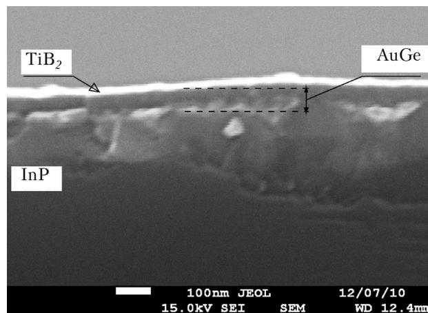
Рис. 11. Морфология скола и поверхности контакта TiB<sub>x</sub>-Ge-Au-InP после БТО при 490°C
