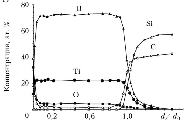
Рис. 3. Морфология поверхности в контакте TiB<sub>x</sub>-n-SiC 6H (а, б) и профили атомного состава по глубине контактной металлизации (в, г) до отжига (а, в) и после БТО при 1000°C (б, г) [21]
