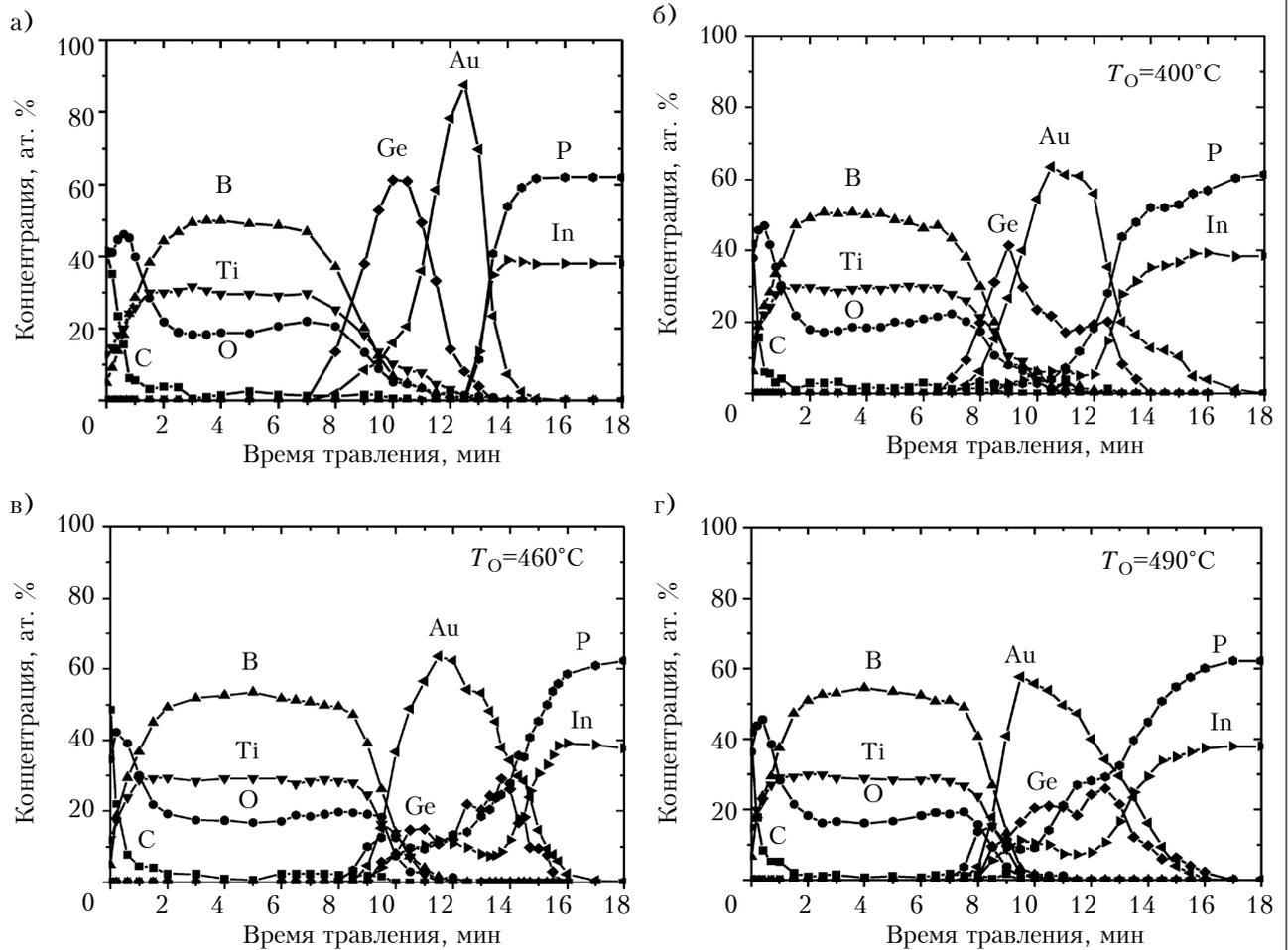
Рис. 12. Профили атомного состава по глубине контактной металлизации в контакте TiB<sub>x</sub>-Ge-Au-InP до отжига (а) и после БТО при разной температуре (б, в, г) [5]
