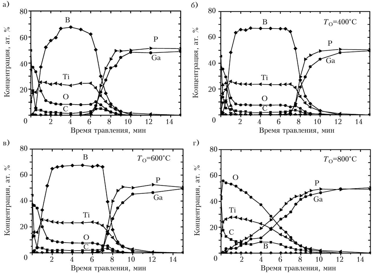
Рис. 8. Профили атомного состава по глубине контактной металлизации в контакте TiB<sub>x</sub>-GaP до отжига (а) и после БТО при разной температуре (б, в, г) [4]
