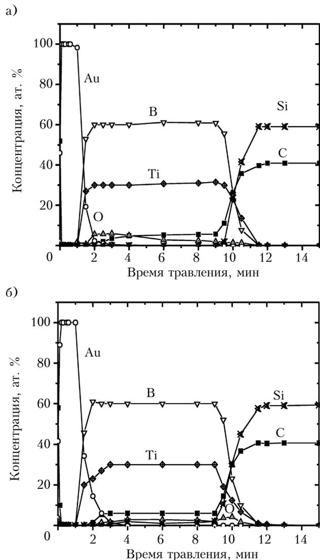
Рис. 4. Профили атомного состава по глубине контактной металлизации в контакте Au-TiB<sub>x</sub>-n-SiC 6H до отжига (а) и после БТО при 1000°С (б) [22]
