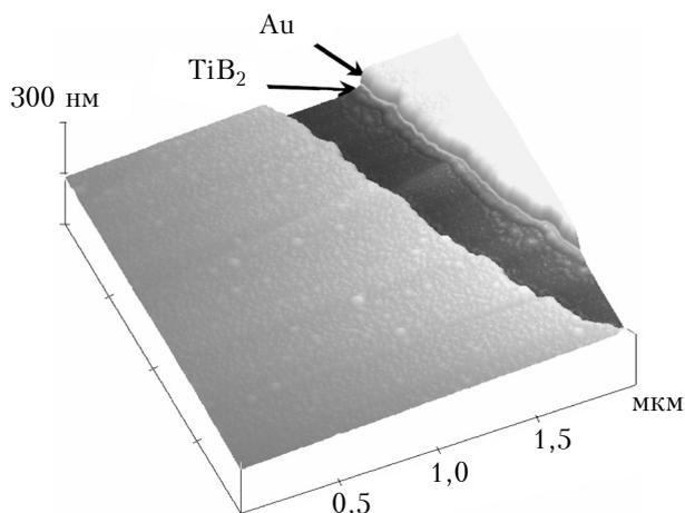
Рис. 5. Морфология поверхности структуры Au-TiB<sub>x</sub>-n-SiC 6H с поликристаллическим слоем TiB<sub>x</sub> после БТО при 1000 °С
