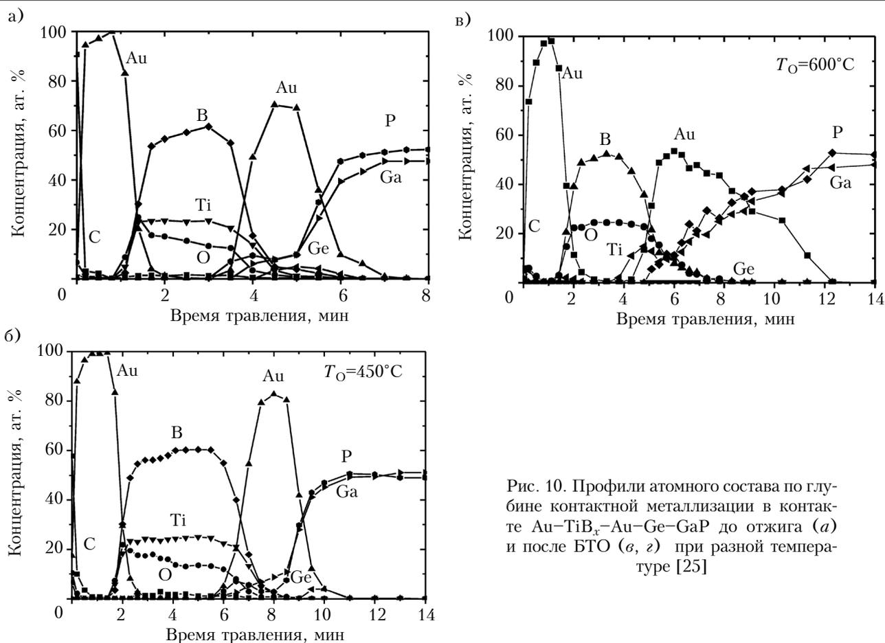
Рис. 10. Профили атомного состава по глубине контактной металлизации в контакте Au-TiB<sub>x</sub>-Au-Ge-GaP до отжига (а) и после БТО (б, в) при разной температуре [25]
