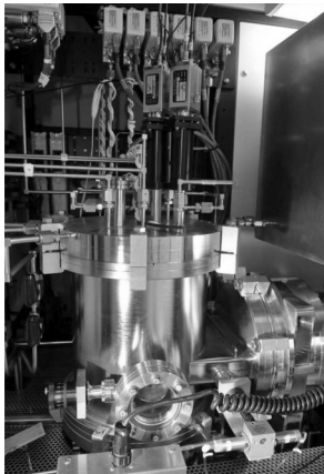
Рис. 1. Установка МОС-гидридной эпитаксии Discovery 180 LDM
