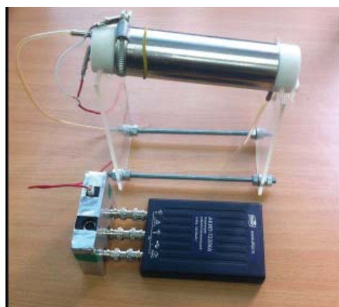
Рис. 3. Портативный измеритель импеданса автомобильного бензина, оснащенный специальной электролитической ячейкой
