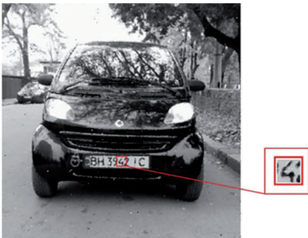
Рис 4. Очищенное с помощью медианной фильтрации с окном [3 \times 3] изображение автомобиля, приведенное на рис. 1
