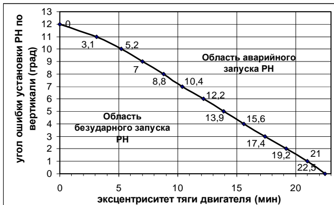
Рис. 3 – Область значений эксцентриситета тяги двигателя и погрешности установки РН по вертикали для аварийного и безударного старта
