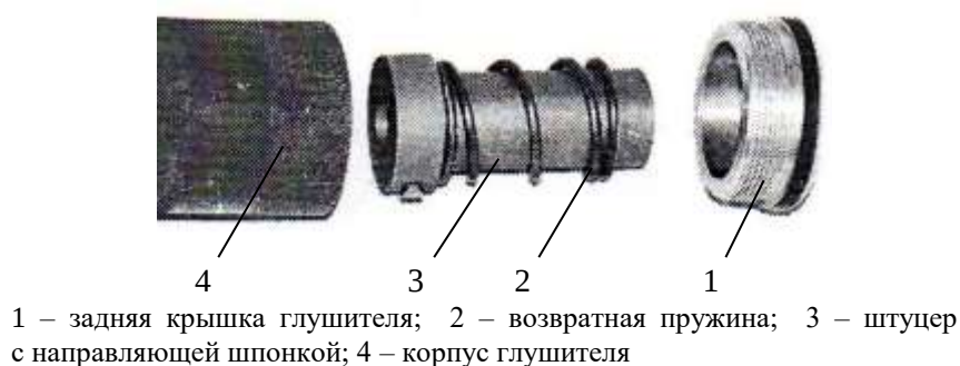
Рис. 4 – Импульсный разъединитель ИТМ НАНУ и ГКАУ
