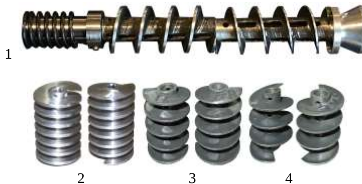
1 – рассекатель; 2 – шнеки с шагом 10 мм; 3 – шнеки с шагом 15 мм; 4 – шнеки с шагом 20 мм
