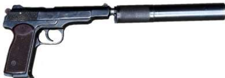
Рис. 2 – Пистолет АПБ с установленным ПСУЗВ
