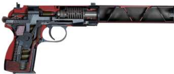
Рис. 1 – Самозарядный пистолет для бесшумной и беспламенной стрельбы – ПБ
