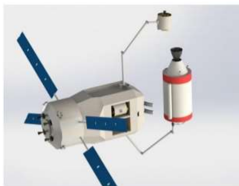
Рис. 1 – Приклад захоплення орбітальної ступені двома маніпуляторами
