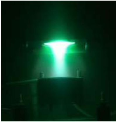
Рис. 8 – Розряд в ПЛН6МРС50. Стационарний незбалансований режим
