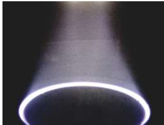
Рис. 1 – Сфокусований потік газових іонів в ПАШ 125
