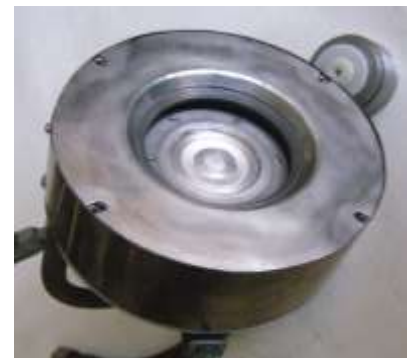
Рис. 2 – Інтегрований іонно-плазмовий пристрій
