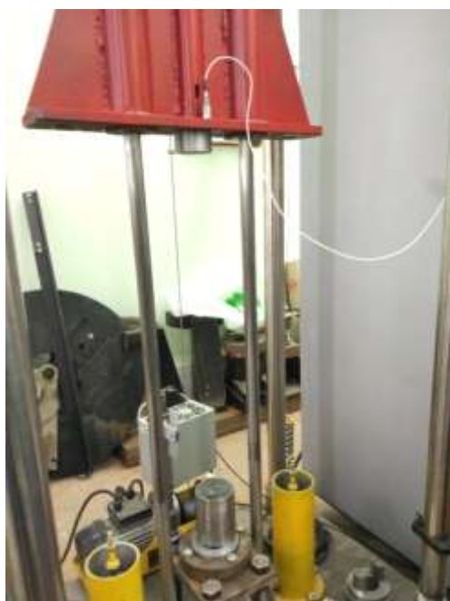
Рис. 3 – Вертикальний копер з датчиками прискорень DYTRAN і встановленим зразком
