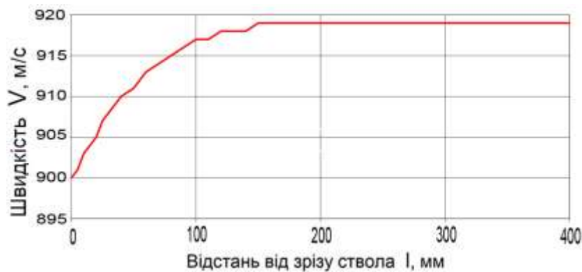
Рис. 5 – Графік швидкості кулі в ПЗРЗП з гелікоїдальним розсікачем для автомата АК-74
