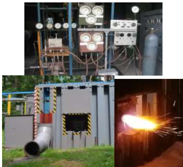
Рис. 7 – Стенд продувок плоских моделей форсункових головок
