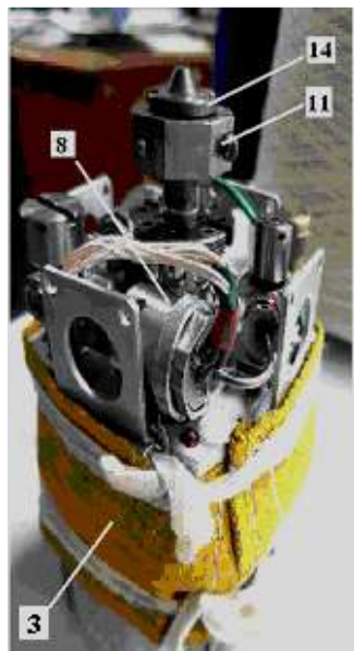
1, 2 – заправні штуцери; 3 – бак монопалива; 4 – витиснювальна мембрана; 5 – монопаливо; 6 – витиснювальний газ; 7 – паливний трубопровід; 8 – електрокерований паливний клапан; 9 – форсуючий пристрій; 10 – шар каталізатора; 11 – електропідігрівач каталізатора; 12 – продукти термokatалітичного розкладу монопалива; 13 – горіння продуктів розкладу монопалива в камері згоряння; 14 – сопловий пристрій
