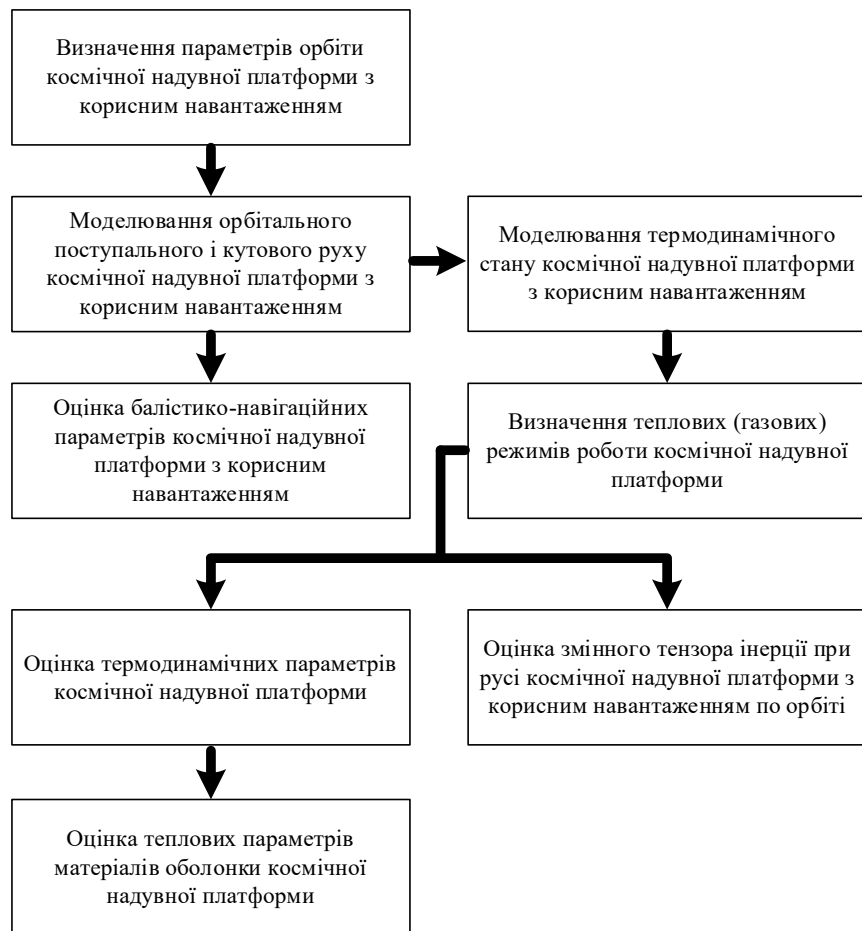
Рис. 3 – Метод оцінки проєктних параметрів космічної надувної платформи з корисним навантаженням із застосуванням математичної моделі (1) – (11)
