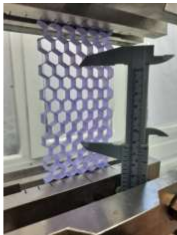
Рис. 2 – Зразок стільникової панелі, встановленої в затискачі
