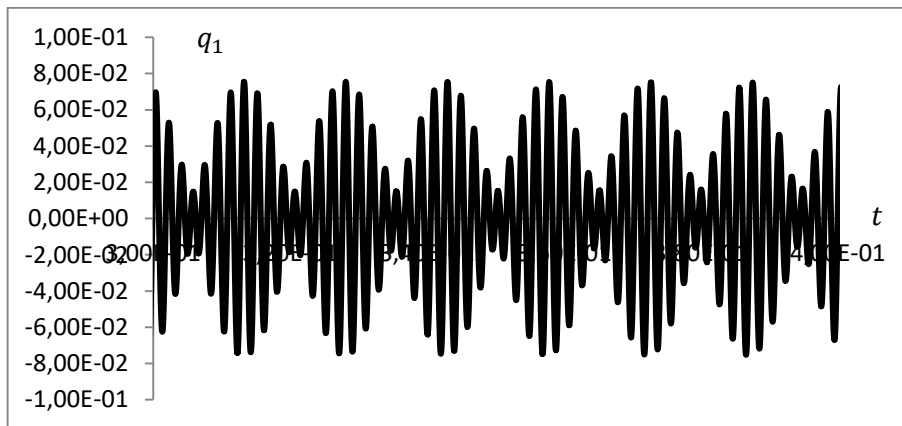
Рис. 3 – Коливання q_1(t) при p_\infty = 13 \cdot 10^5 Па
