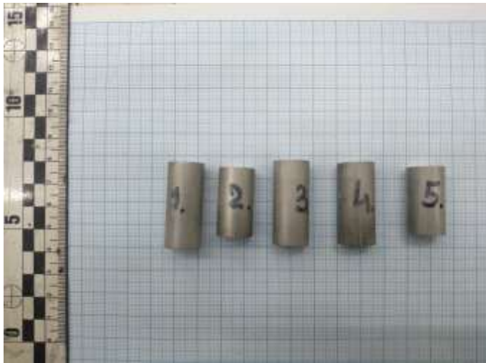
Рис. 12 – Модельні зразки ПЕПЕ з порошків алюмінію та алюмінієвих сплавів [7]
