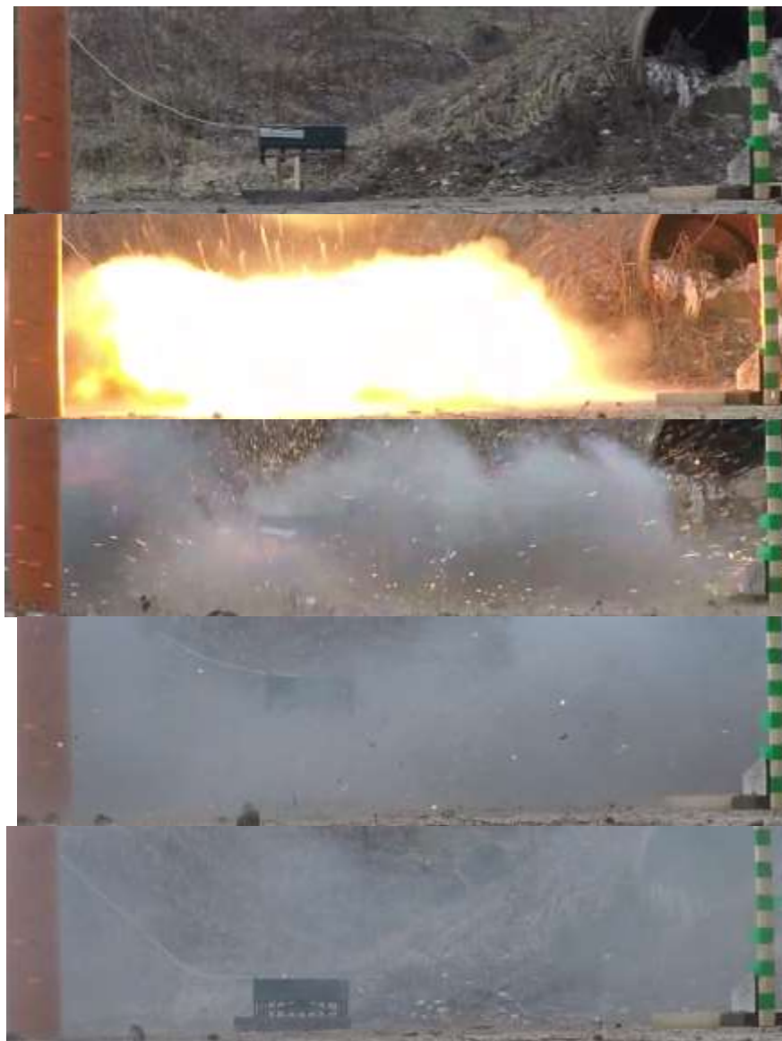
Рис. 11 – Кадри підриву макета корпусу ББМ
