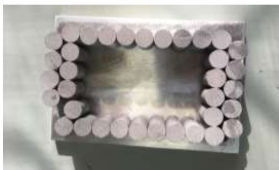
Рис. 14 – Модельний зразок комбінованого ЗПМЕ відкритого типу
