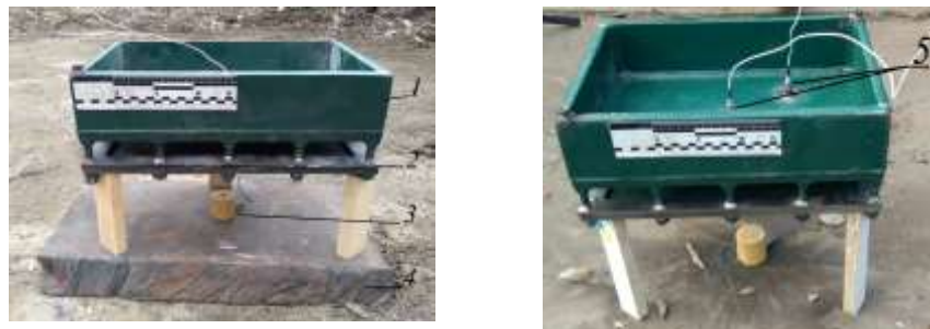
1 – макет корпусу ББМ; 2 – ЗПМЕ; 3 – заряд ВР із детонатором; 4 – металева плита товщиною 70 мм; 5 – датчики прискорення
