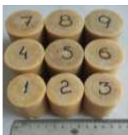
Рис. 3 – Загальний вигляд зарядів ВР (ТГ-50/50)
