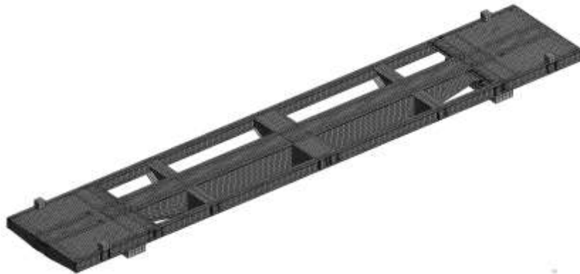
Рис. 6 – Скінченно-елементна схема вагона-платформи з контейнером
