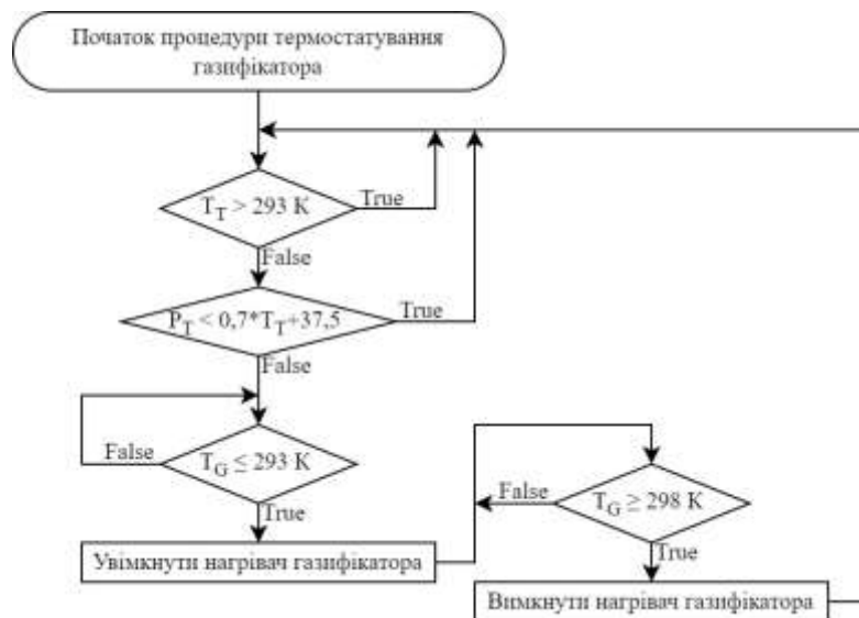
Рис. 3 – Методика роботи газифікатора
