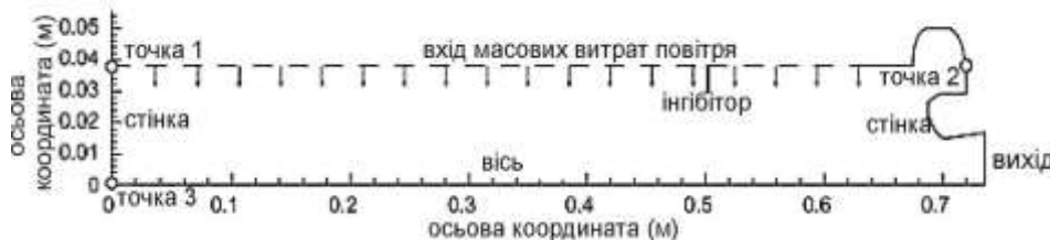
Рис. 3 – Розрахункова схема течії газу в камері тестового двигуна [18]
