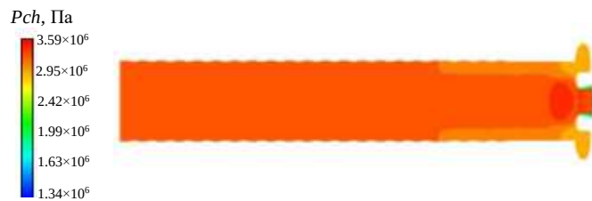
Рис. 6 – Діаграма розподілу розрахункового тиску в камері VKI
