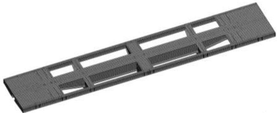
Рис. 8 – Скінченно-елементна схема рами екіпажної частини вагона
