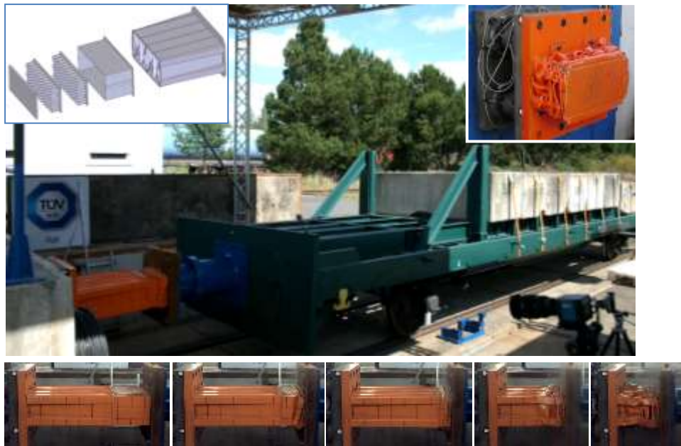
Рис. 10 – Креш-тест прототипу ППЕ для локомотива
