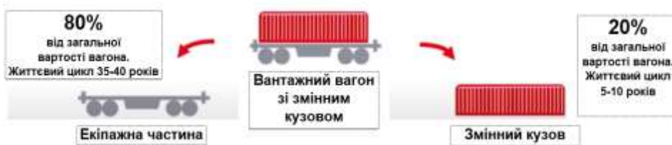
Рис. 2 – Новий вид вантажного рухомого складу залізниць – вагон зі змінним кузовом
