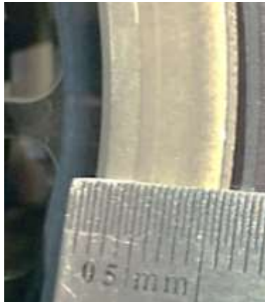
б) Зовнішній ізолятор після 8-ми годинних випробувань
