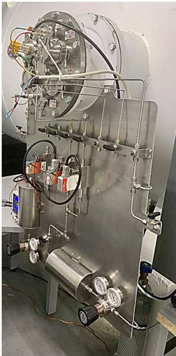
Рис. 10 – Лабораторна система подачі ксенону
