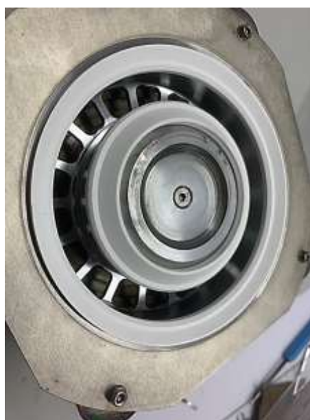
Рис. 6 – Загальний вигляд модернізованого холловського двигуна ST-100M
