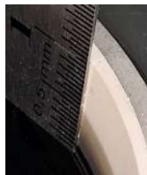
б) Зовнішній ізолятор після 120-ти годинних випробувань
