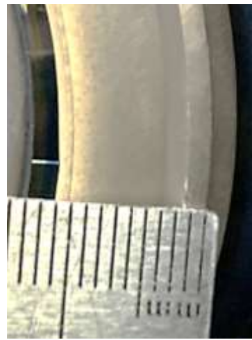
б) Внутрішній ізолятор після 8-ми годинних випробувань
