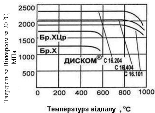
Рис. 4. Зміни твердості різних матеріалів на основі міді залежно від температури відпалу [40].
