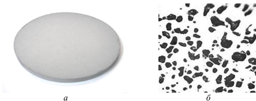
Рис. 7. Спечена за оптимальних умов мішень (а) і мікрофотографія зразку-свідка з пористістю 19% (б).
