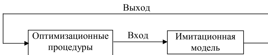
РИС.2. Координация между оптимизатором и имитационной моделью
