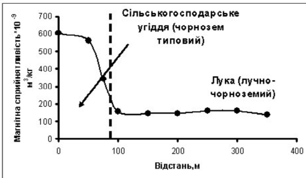
Рис. 5. Графік розподілу магнітної сприйнятливості ґрунтового покриву при перетині основних форм рельєфу Яблунівського нафтогазоконденсатного родовища
