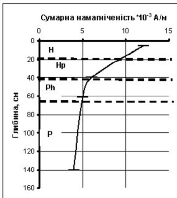
Рис. 4. Розподіл сумарної намагніченості з глибиною для ґрунтового покриву нафтового родовища Селюхи
