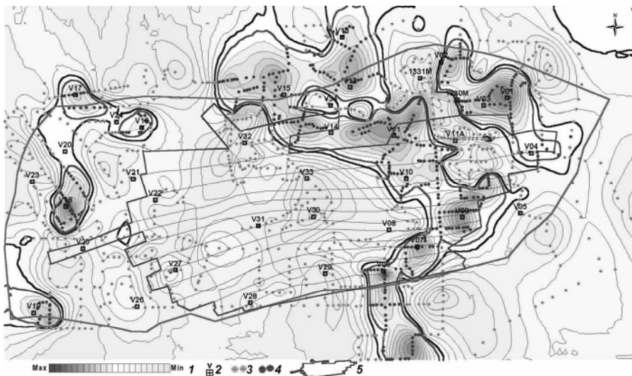
Рис. 3. Карта-схема аномалий СКИП типа “залежь”. 1 – контуры выработки по пласту h_{10} , 2 – шкала интенсивности аномалий СКИП (аномалии типа “газонасыщенный пласт” – темный цвет); 3 – пункты ВЭРЗ; точки значений СКИП: 4 – отрицательных, 5 – положительных
