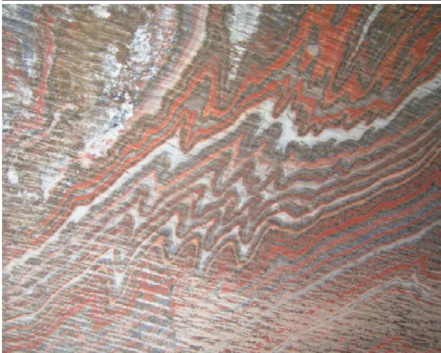
Рис.3. Пример складчатости слоев сильвинита (стенка горной выработки)
