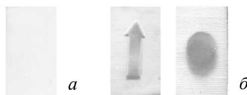
Рис. 4. Потемнение оптически прозрачного образца ОНВ-3 (а) после УФ-облучения (б).
