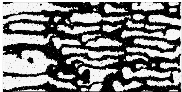
Рис. 4. Структура 2D-сплаву за умов фіксованого струму і періодичних крайових умов на атомні потоки (після 7500 МК-кроків, решта параметрів відповідають наведеним вище)
