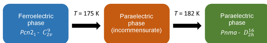
Рис. 1. Схема температурного розміщення фаз та фазових переходів кристала (\text{NH}_4)_2\text{BeF}_4
