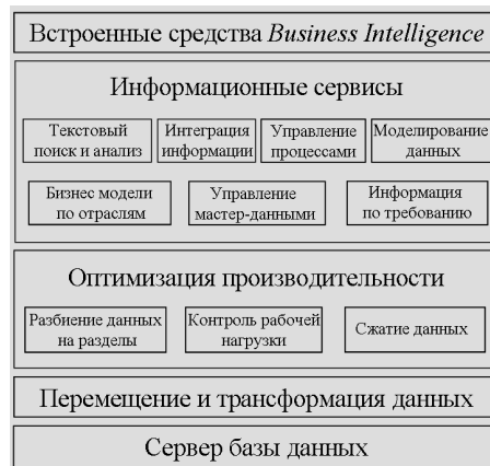
Рис.3. Упрощенная архитектура динамического хранилища данных
