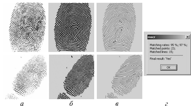
Рис. 1. Реализация технологии сравнения двух изображений отпечатков пальцев: a – исходная пара изображений; б – результат фильтрации и бинаризации; в – векторизация и выделение особых точек; г – принятие решения об идентичности двух сравниваемых изображений на основе поиска соответствующих точек
