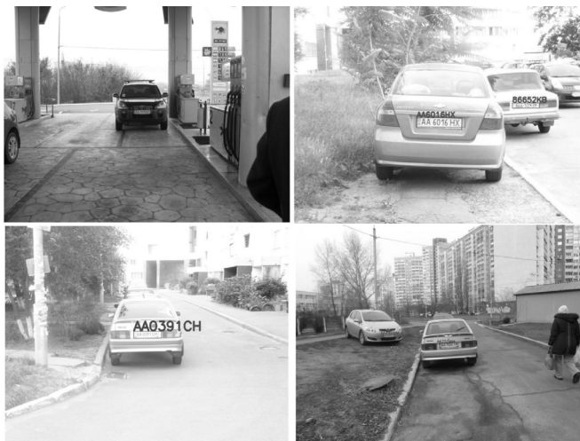
Рис. 6. Примеры распознавания автомобильных номеров на изображениях
