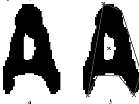
Рис. 3. a – бинаризованное изображение символа; b – четыре особые точки (обозначены крестиками) на этом изображении: 3 основные особые точки на аппроксимированном контуре изображения (концы линий) и одна дополнительная особая точка (центр внутреннего контура на изображении буквы A )
