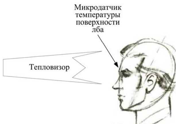
Рис. 1. Схема измерений плотности теплового потока ото лба человека и температуры в центре лба (разработана на основе описания экспериментов в работе [21])
