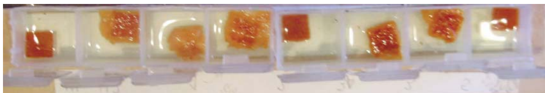
Рис.3. Вид образцов в последний день выдержки в азотной кислоте. Слева направо – образцы Н1, Н2, А50, А100, А200, А300а, А300, А500
