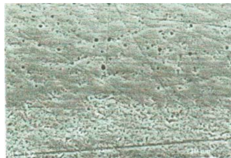
Рис. 4. ГФП Ni-B+CrSi 2 після термообробки при T=1080°C, τ=300 с, x200
