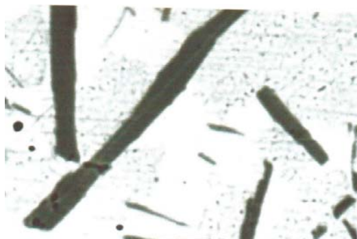
Рис. 6. Мікроструктура ГФП Ni-B+CrSi 2 , T=1120 °C, τ = 5с, x1500
