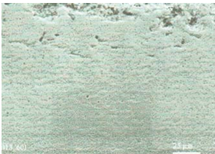
Рис. 3. ГФП Ni-B+CrSi 2 після термообробки при T=1080°C, τ=5с, x200
