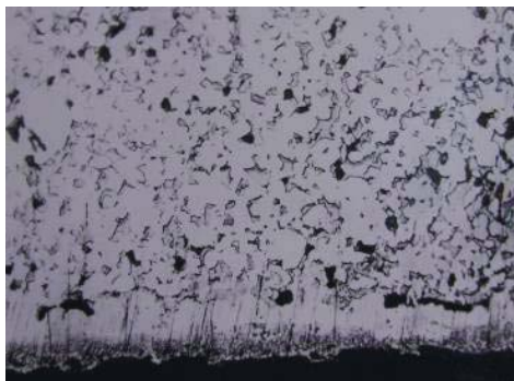
Рис. 5. Мікроструктура ГФП Ni-B + Cr 3 C 2 , T=1080 °C, τ = 5с, x500
