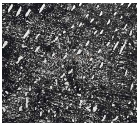
Рис. 2. Микроструктура переходной зоны обезуглероженного ванадийсодержащего чугуна: а – до деформации, б, в – после деформации; а – \times 200 , б – \times 600 , в – \times 400
