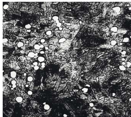
Рис. 5. Микроструктура диффузионной зоны обезуглероженного ванадийсодержащего чугуна после деформации и науглероживания; \times 400
