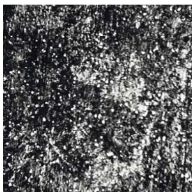
Рис. 2. Микроструктура переходной зоны обезуглероженного ванадийсодержащего чугуна: а – до деформации, б, в – после деформации; а – \times 200 , б – \times 600 , в – \times 400
