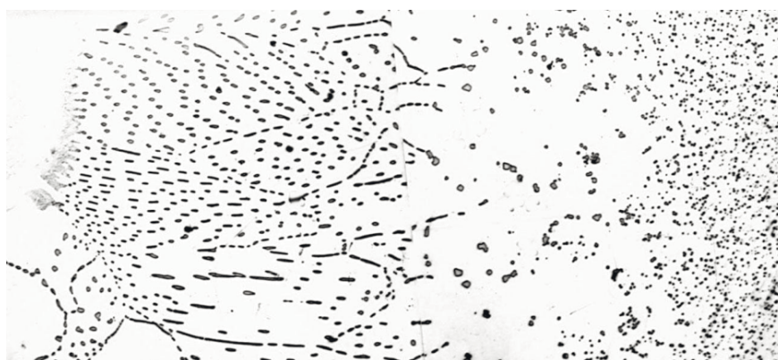
Рис. 1. Микроструктура обезуглероженного ванадийсодержащего чугуна после деформации в жидко-твердом состоянии: а – сердцевина, б – поверхность; \times 400
